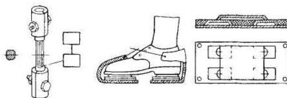
Рис. 1. Тензометрическая ручка и обувь для замера усилий, прилагаемых к рычагу (педали) управления станком.
